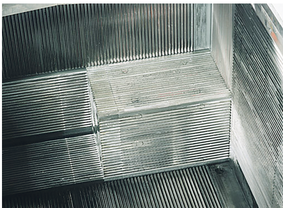
Schleißblechauskleidung des Presskastens einer Paketierpresse
