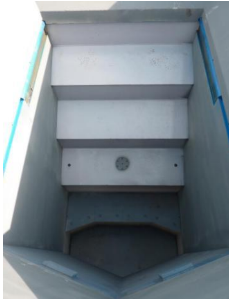
Bild 68: Blick vom Aufgabebunker in den Scherraum mit Vorverdichter + Messerschlitzen
