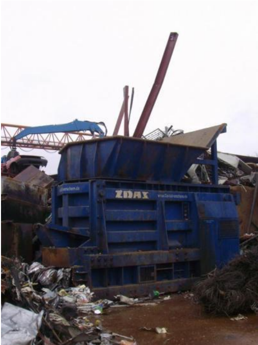
Bild 15: Träger in Containerschere
