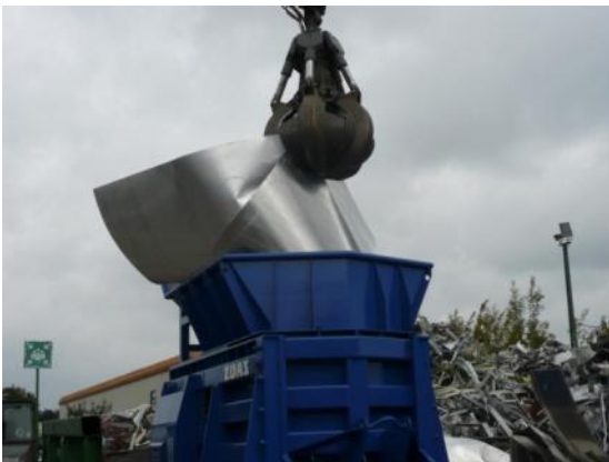
Bild 42: ALU-Bleche in Aufgabebunker
