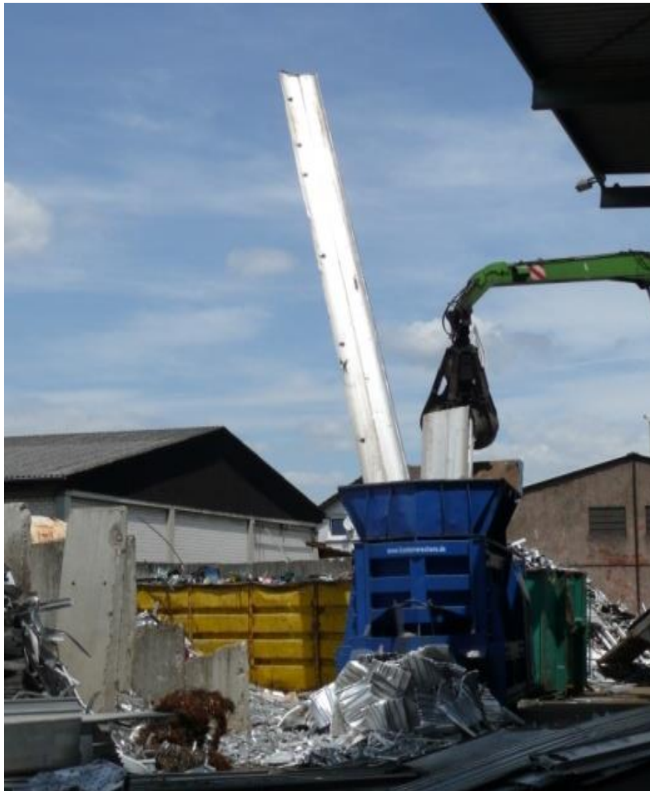
Bild 46: langes Alu-Profil im Aufgabebunker
