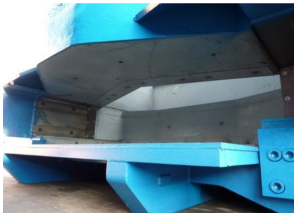
Bild 70: Blick von vorne durch die Austragsöffnung in den Scherraum mit Messerschlitzen + Gegenmesser
