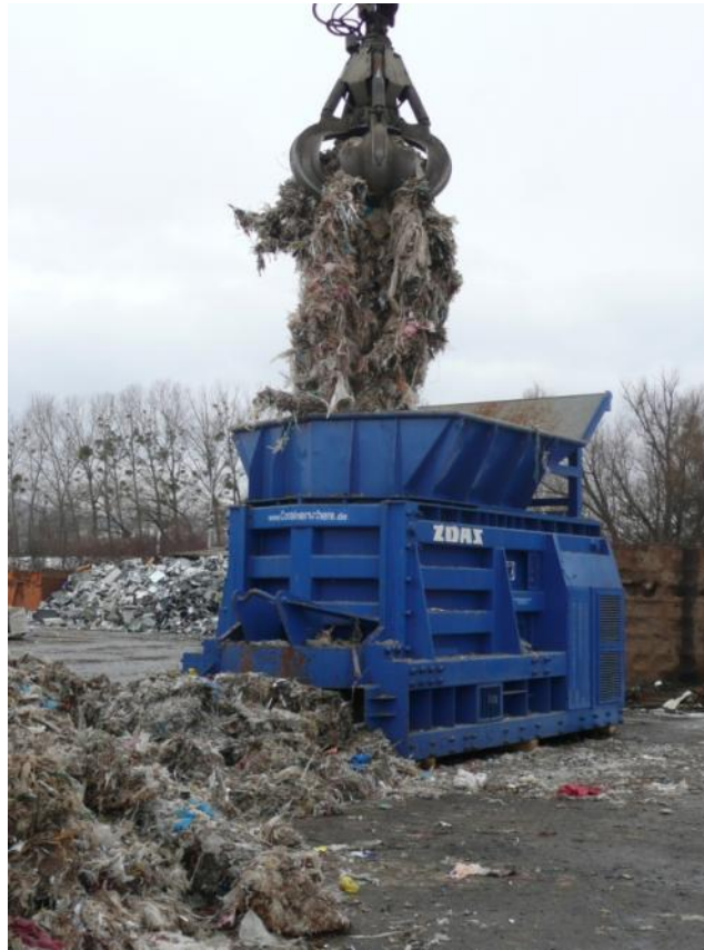
Bild 60: Zöpfe chargieren (Drahtgeflecht mit Kunststoffanteil)
