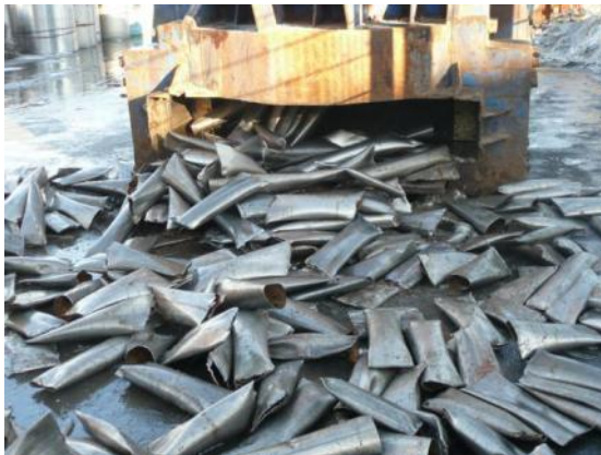
Bild 23: Trägerschrott in Aufgabebunker
