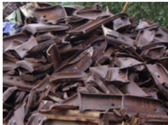
Fig. 18: Traverses métalliques cisailés
