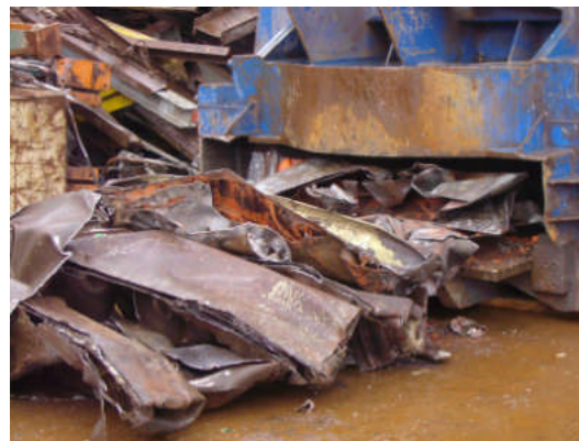
Fig. 4: Contenant après cisailage
