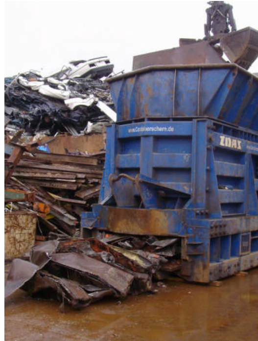
Fig. 2: Contenant après cisailage
