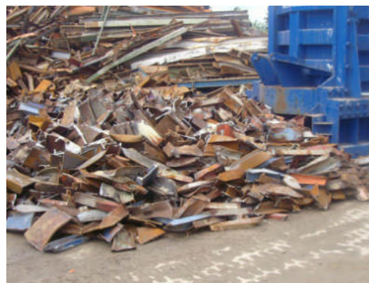
Fig. 20: Ferraille de construction après cisailage
