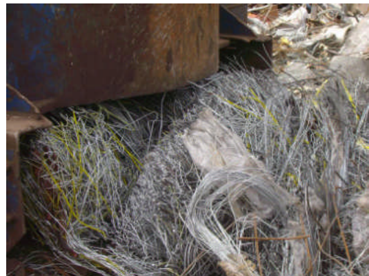
Fig. 55: Fils métalliques cisailés
