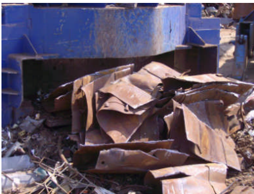
Fig. 3: Contenant après cisailage
