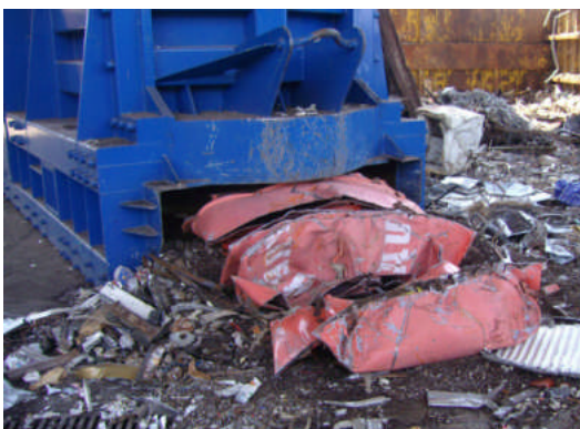
Fig. 5: Contenant après cisailage
