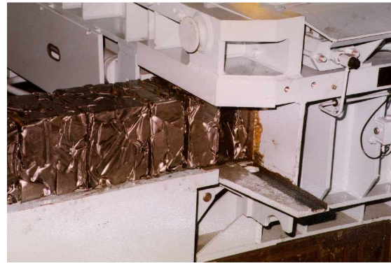
Bild 3: Packetauswurf nach dem Pressvorgang mit zusätzlichem Abscheren des überstehenden Materials (dadurch werden saubere Pakete erzielt!)
