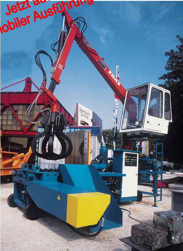
Bild 1: Paketierpresse CPB 100 mit Zusatzausrüstungen (hydr. Greifer, Steuerkabine, Paketrampe, Schwerlast-Fahrwerk)
