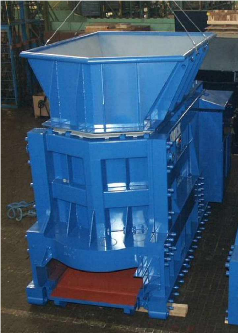
Bild 1: Containerschere CNS 320 K mit Aufgabebunker
